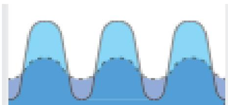
Использование компрессионной подложки при лакировании современными лакировальными полотнами имеет фундаментальное значение. Т.к. лакировальные полотна, в отличие от резинотканевых полотен, не имеют компрессионного слоя. И они не
