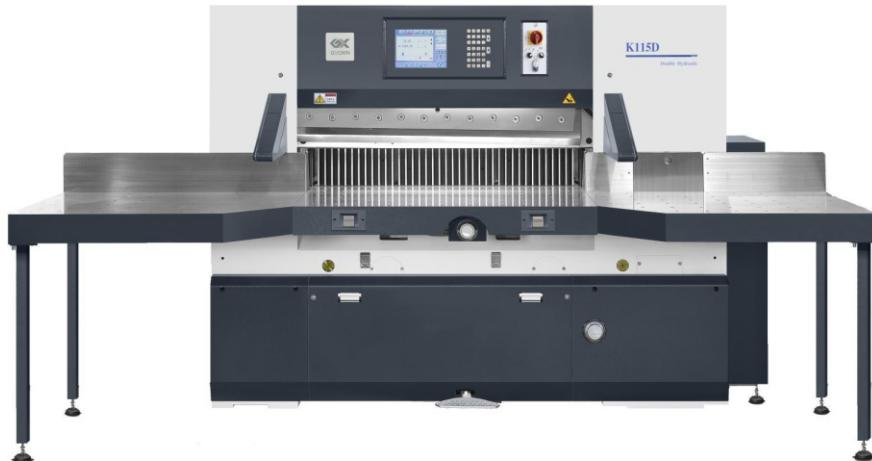
Одноножевая бумагорезательная машина для резки бумаги на форматные листы. Оснащена гильотинным ножом, который может резать стопу бумаги до 165 мм в высоту и до 1150 мм в ширину.
